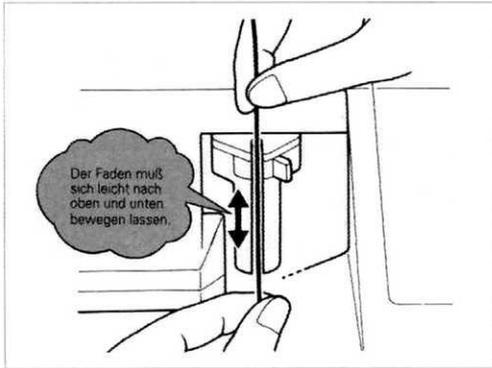
2) Den gespannten Faden einlegen und nach oben sowie nach unten bewegen.
