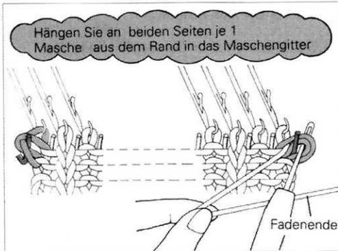
1. Mit der Deckernadel fassen Sie je 1 Masche an beiden Strickrändern unterhalb der Randmaschen auf und hängen diese, wie im Bild gezeigt in die Haken des Maschengitters. (Damit das Strickstück beim Abketten nicht von der Maschine abfällt.)
