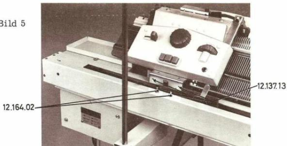
7. Kupplungsplatte, Pos. 12.137.13, welche am Keilriemen des Antriebes hängt, mit den 2 Schrauben 12164.0.2 am Mitnehmer befestigen, Bild 5.
