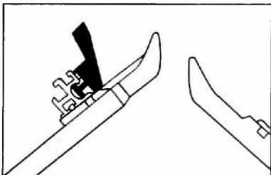
2. Das untere Teil der Reihenzählerkulissee gemäss Abbildung von links in die obere runde Öffnung der oberen Führungsschiene des hinteren Bettes einführen und sie bis zur Randfeder schieben. Damit man die Zählerkulissee verschieben kann, muss man sie etwas nach vorne drücken. Wenn Sie die Zählerkulissee loslassen, rastet sie ein und sitzt dann fest.
