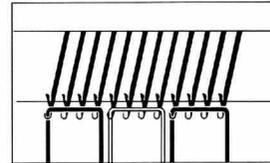
4. Das Intarsienschloss jetzt von links nach rechts über die Nadeln führen. Diese werden dadurch in Einlegstellung gebracht. Bringen Sie den Reihenzähler 4 des Picto auf den Stand des Reihenzählers am Strickschloss.
