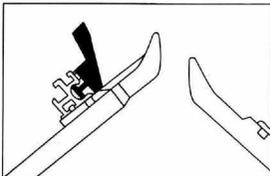
2. Das untere Teil der Reihenzählerkulissee gemäss Abbildung von links in die obere runde Öffnung der oberen Führungsschiene des hinteren Bettes einführen und sie bis zur Randfeder schieben. Damit man die Zählerkulissee verschieben kann, muss man sie etwas nach vorne drücken.
